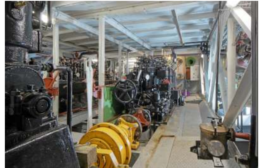
Maschinenraum. Mitte: eine der beiden Maschinen; gelb: Kupplung; links: alter Hilfsdiesel für Strom und Druckluft
